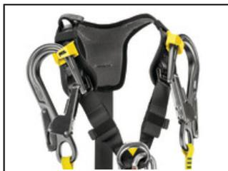
Les connecteurs MGO des longes d'antichute peuvent être rangés sur chaque bretelle. Ainsi, l'utilisateur n'est pas gêné par la longe et les connecteurs restent à portée de main. En cas de chute, ce système permet le déploiement de l'absorbeur en libérant les MGO.
