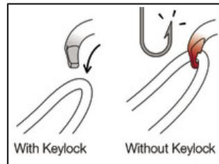
Pour garantir une efficacité optimale lors des manœuvres, les mousquetons OK utilisent le système Keylock : l'interface, composée du corps et du doigt, est dépourvue de crochet, afin d'éviter l'accrochage involontaire du mousqueton sur l'ancrage, la corde, le porte-matériel du harnais...
