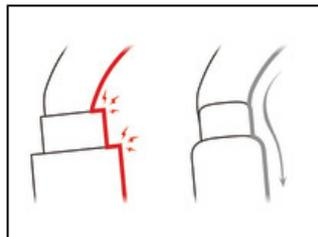
Le design intérieur fluide des mousquetons OK limite le risque de point stable et facilite la rotation du mousqueton.
