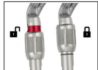
Pour faciliter le contrôle du matériel, les mousquetons à verrouillage manuel SCREW-LOCK possèdent un repère visuel de couleur rouge, visible uniquement lorsque le doigt du mousqueton n'est pas verrouillé.
