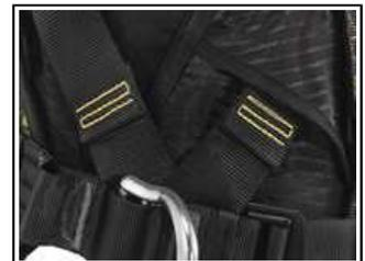
Témoins de chute sur les points d'attache sternal et dorsal. Leur activation après une chute indique que le harnais doit être mis au rebut.
