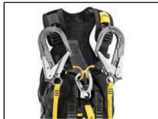
Les connecteurs MGO des longes d'antichute ABSORBICA peuvent être rangés sur chaque bretelle. Ainsi, l'utilisateur n'est pas gêné par sa longe et les connecteurs restent à portée de main. En cas de chute, un système permet le déploiement de l'absorbeur en libérant les MGO.
