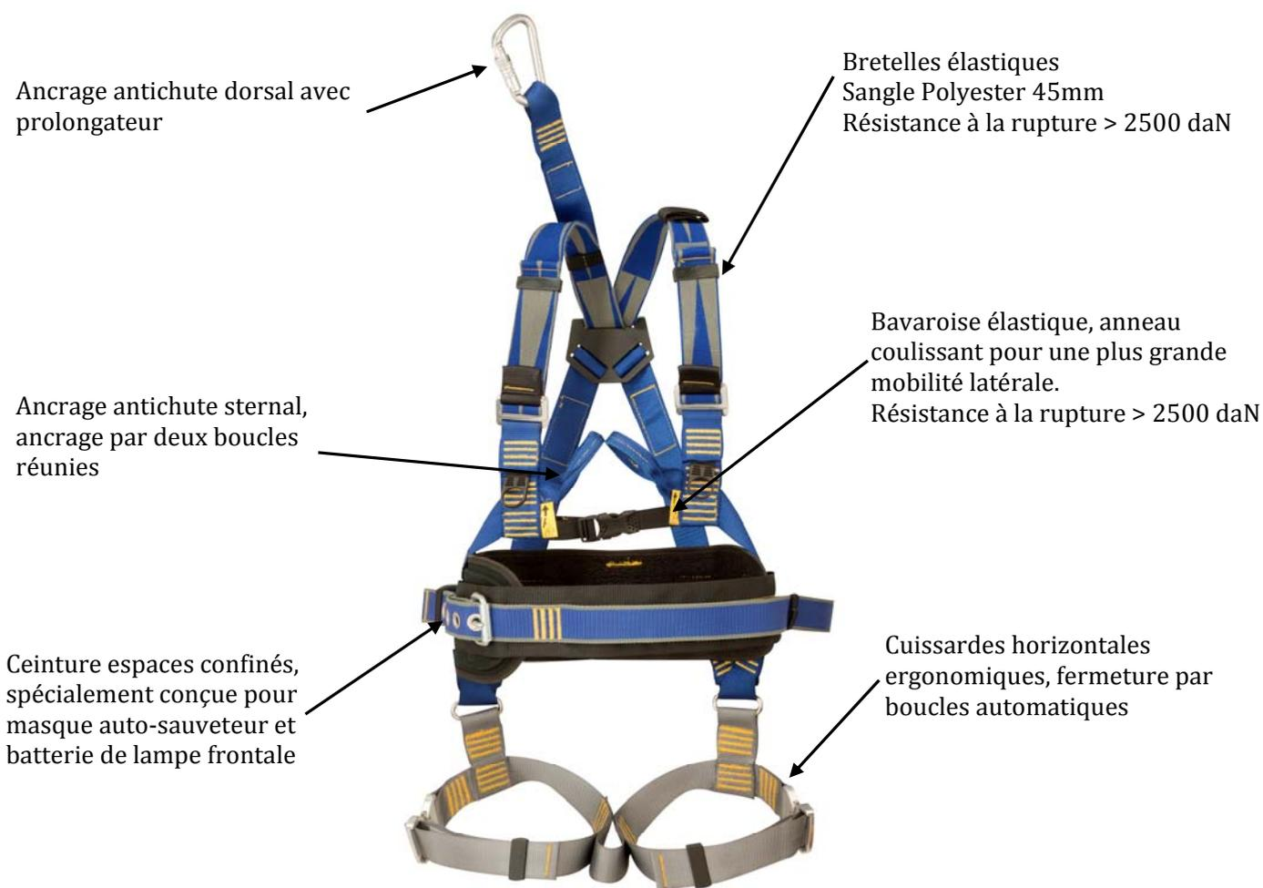
**Produit et utilisation :** Harnais antichute ouvrable comportant : un point d'amarrage dorsal (muni d'un prolongateur), un point d'amarrage sternal via deux boucles réunies. Cuissardes horizontales ergonomiques : épouse les mouvements. Equipé d'une ceinture spécialement conçue pour masque auto-sauveteur et batterie de lampe frontale.
