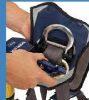
Ouvrez le connecteur en enfonçant vers l'intérieur la pièce rapportée en matière plastique et le mousqueton. Faites passer l'avant du mousqueton dans le tourillon du bloc puis faites le tourner de l'autre côté.
