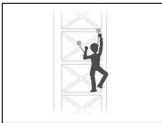
Les longes à deux brins ABSORBICA-Y permettent de rester assuré lors du passage d'un fractionnement, en déconnectant puis reconnectant successivement les deux brins.
