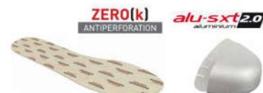
Nouveau embout en aluminium avec épaisseurs variables et fonctionnelles, avec morceau de caoutchouc. Résistant au choc de plus de 200J. Semelle intercalaire tissée. Résistant à plus de 1100 N à perforation zéro
