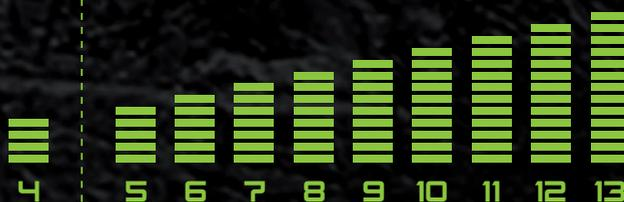
La régulation automatique du niveau de protection ajuste automatiquement le niveau de teinte appropriée dans la plage allant de 5 à 13 ; Cela est assuré par un capteur de luminosité supplémentaire qui mesure l'intensité de l'arc de soudage. Ainsi, vous êtes toujours parfaitement protégé, peu importe les paramètres de soudage avec lesquels vous travaillez. Les ajustements manuels ne sont alors plus nécessaires. Mais restent disponibles sur simple pression d'un bouton.
