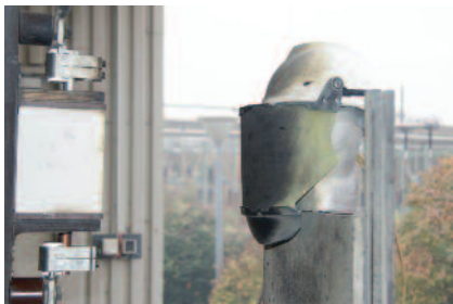
Certification obtenue conformément à la norme GS-ET-29 classe 2–7 kA. L'ensemble tête et visage protège l'utilisateur
