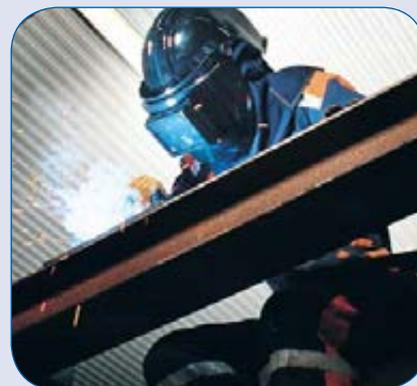
\* Le casque HT-748 répond aux exigences de résistance de base (A) de la norme EN 14594. Il est homologué pour être utilisé avec une gamme de tuyaux d'alimentation en air comprimé conforme aux exigences de résistance de base (A) ainsi qu'aux exigences de résistance plus élevées (B).
