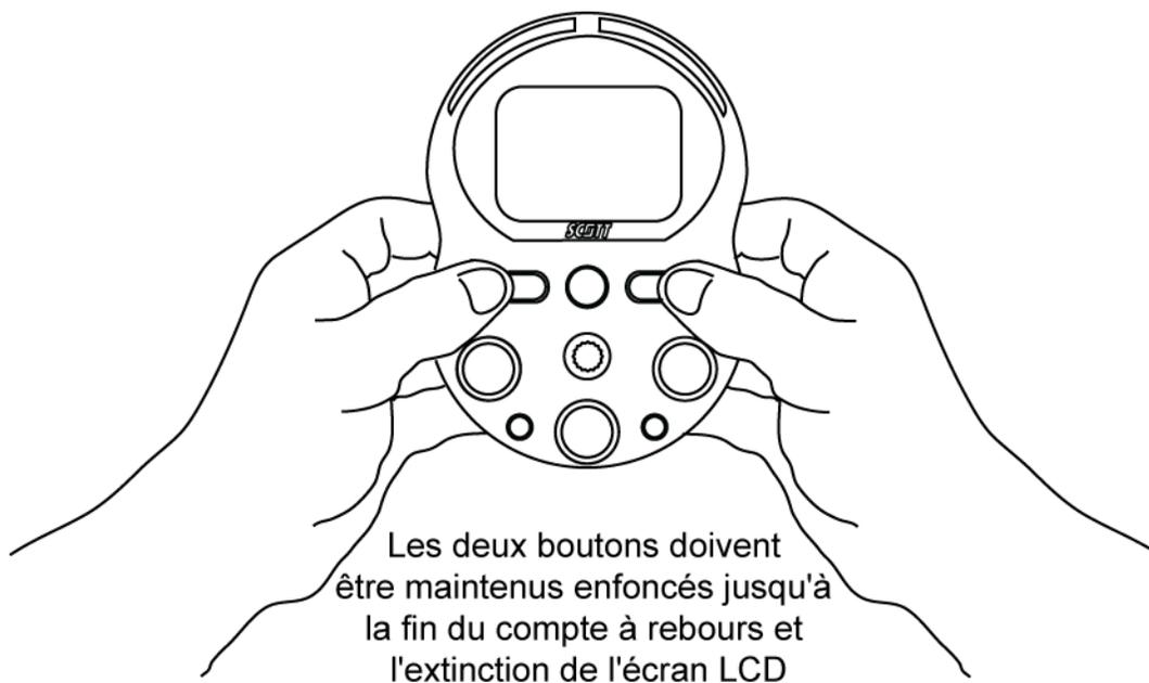
Figure 4-2. Mise hors tension du Protégé
