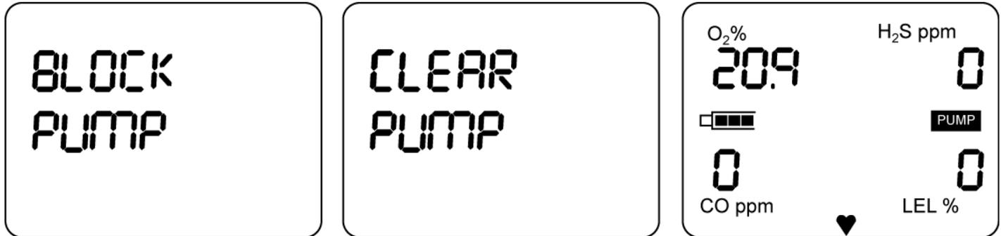
Figure 4-8. Configuration de la pompe
