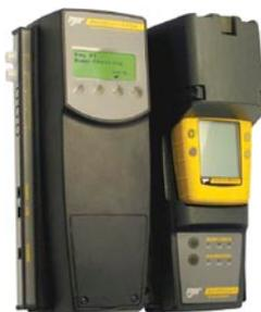
La configuration avec diffusion et la configuration avec pompe sont toutes les deux compatibles avec le système d'étalonnage et de test fonctionnel automatiques MicroDock II.
